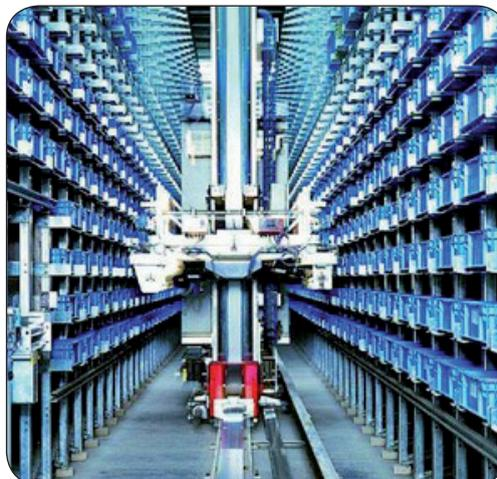
Regalbediengerät in automatischem Kleinteillager
