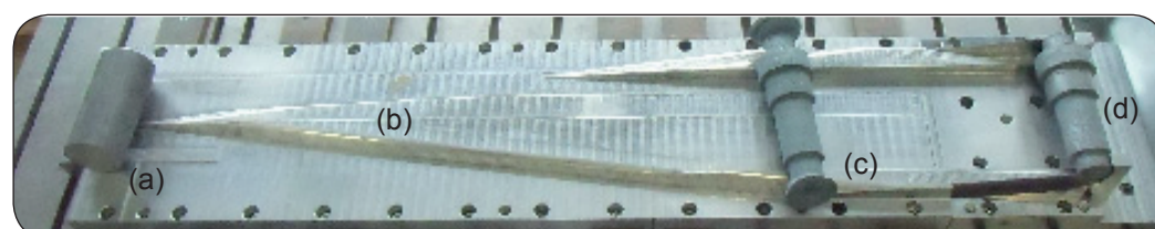
(a) Anfangsform, (b) keilförmiges Flachbacken-Werkzeug, (c) Zwischenform, (d) Endkontur
