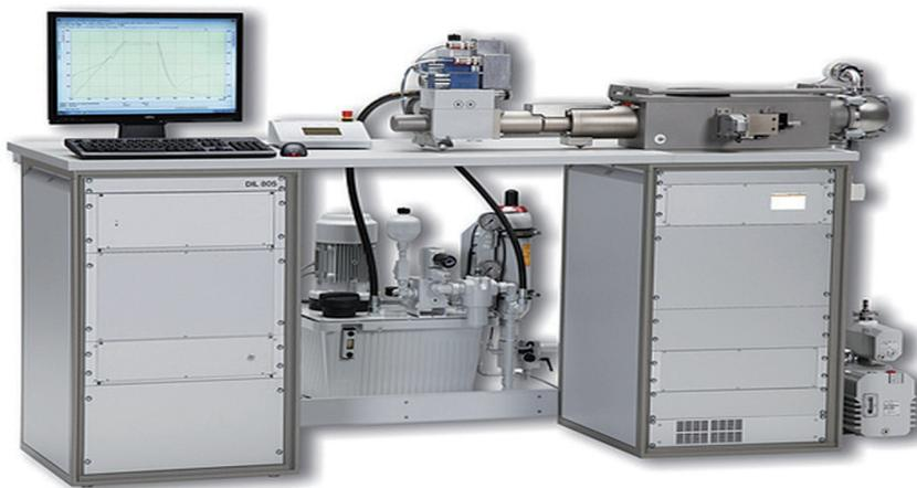
Abb. 2: BÄHR Umformdilatometer zur Ermittlung des Umwandlungsverhaltens © TA Instruments
