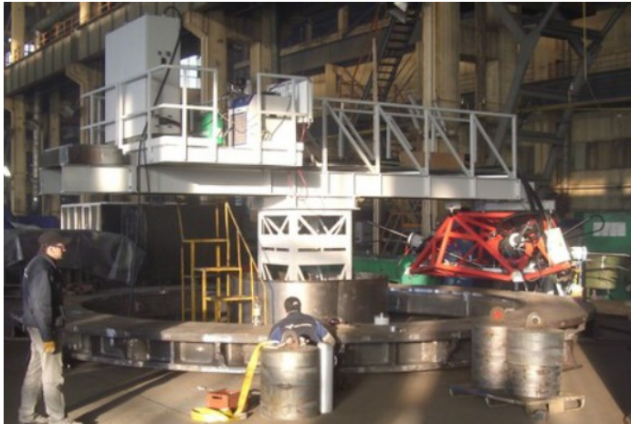
mobile Fräseinheit für Kraftwerks-Instandsetzung (METROM / IWU)
