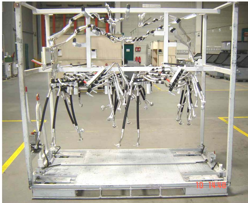
Kältemittelleitung (Quelle: BMG Glauchau)
