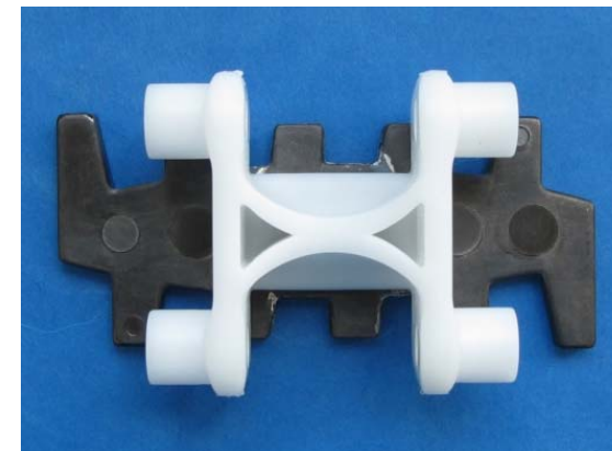
Abb.: Beschichtung der Tragplatten von Kettengliedern aus Kunststoff mittels hafter amorpher Kohlenstoffschichten (a-C-Multilayer)
