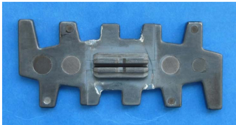
Abb.: Beschichtung der Tragplatten von Kettengliedern aus Kunststoff mittels hafter amorpher Kohlenstoffschichten (a-C-Multilayer)
