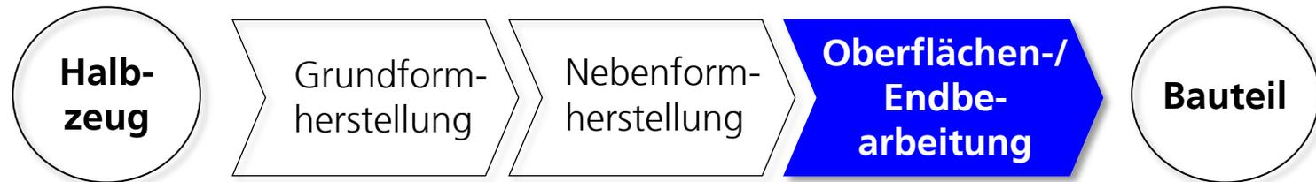
Einordnung der Endbearbeitung in der Prozesskette eines (Präzisions-) Bauteils
