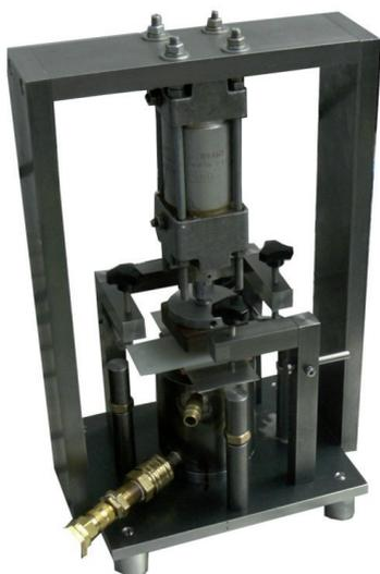
Versuchsaufbau für Kopfzugproben
