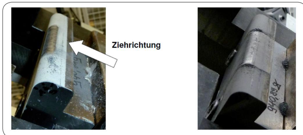
Bild 2: Verschleißbilder nach 5 Überziehversuchen mit Blechstreifen 22MnB5 + AISi, links:  $Zr_2O_3/Y_2O_3-97/3$ , rechts: WC/Co-88/12
